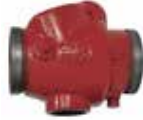
AVK serie 5190/20 Terugslagklep Zachtdichtend Veerbelast (shotgun type) Gegroefde uiteinden volgens AWWA C6060 DN 50-200 24,1 bar (350 PSI) UL/ULC listed, FM approved
